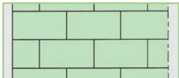
Fig. 9: Esquema de la instalación de planchas de Styrodur C con juntas al tresbolillo. Se evitarán las juntas cruzadas.
