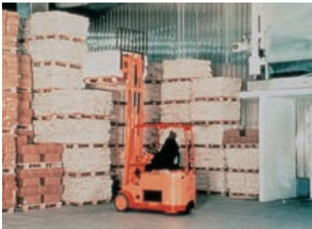
Fig. 14: La carretilla elevadora y el material almacenado cargan el suelo con aislamiento térmico de la cámara frigorífica.
