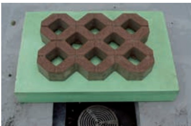
Fig. 8: Resistencia a la compresión de Styrodur C.
