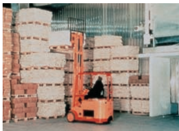
Fig. 4 : Les chariots-élévateurs et la marchandise stockée exercent une forte contrainte sur le sol thermo-isolé de l'entrepôt frigorifique.
