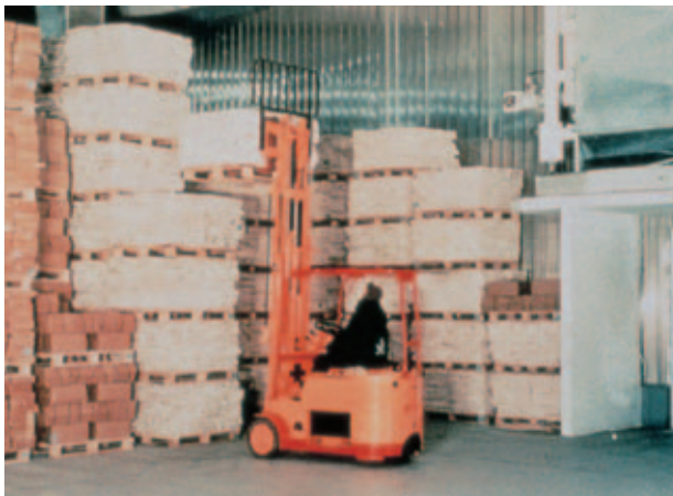
Fig. 14: Il carrello elevatore e le merci stoccate producono sollecitazioni a carico dei pavimenti del deposito frigorifero isolato termicamente.
