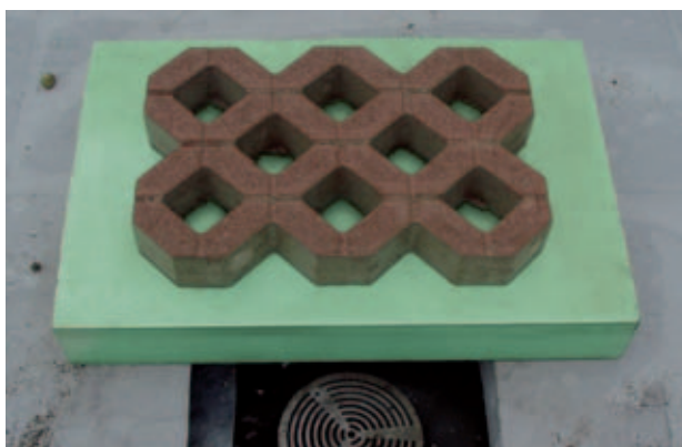
Rys. 8: Wytrzymałość na ściskanie izolacji Styrodur C.
