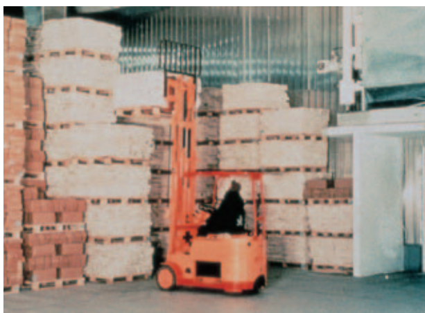
Rys. 14: Wózek widłowy i magazynowany towar stanowią obciążenie ocieplonej posadzki chłodni.
