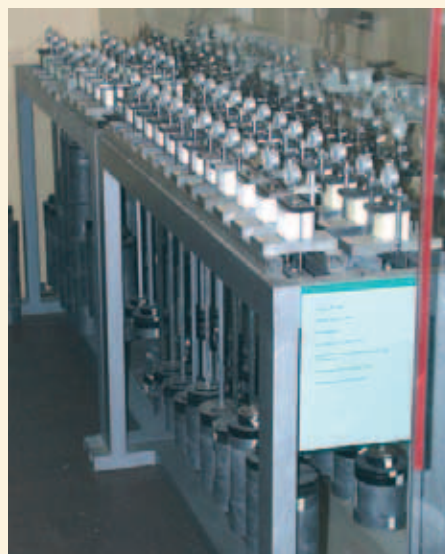
Abb. 5: Prüfstand für Zeitstandsdruckfestigkeitsmessungen an Hartschaumstoffen.
